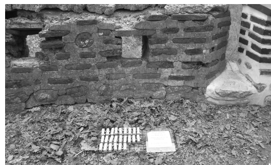
〈그림 6〉 원형 줄눈 성분 분석에 따른 양외 풍화실험(남한산성 동장대)
